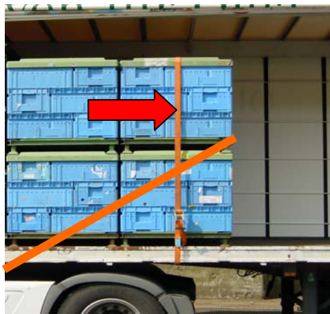
Abb. 32 Niederhaltezurrung letzte Stapel-Ebene und Diagonalzurren
