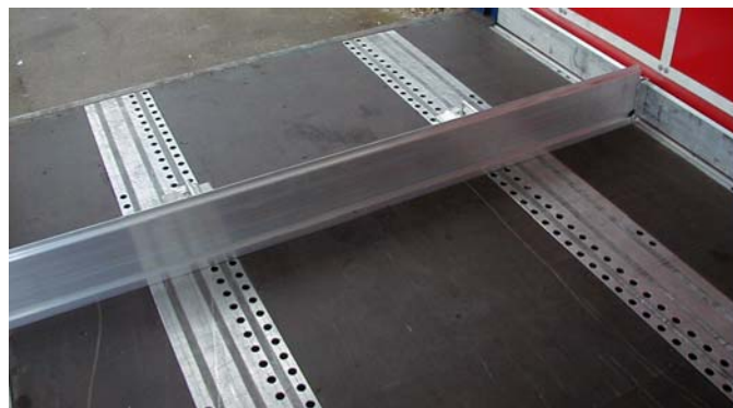
Abb. 22 Anordnung Lochschiene und Sperrbalken
