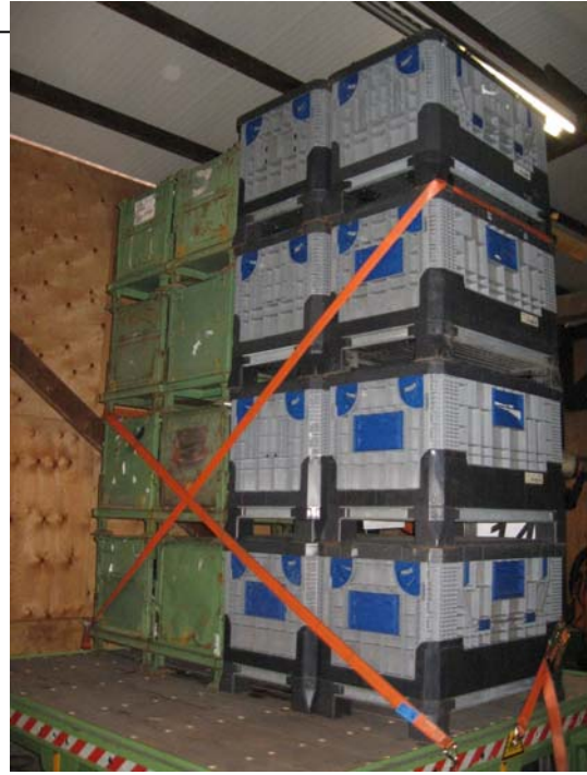
Abb. 13 Seitliche Diagonalverzurrung der LT 2671 über Füße der 4. Ebene
