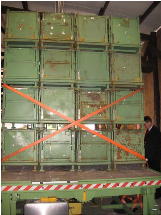
Abb. 30 Seitliche Diagonalverzurrung der LT 2071 über Füße der 3. Ebene
