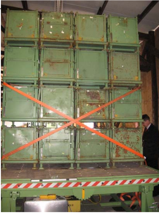
Abb. 12 Seitliche Diagonalverzurrung der LT 2071 über Füße der 3. Ebene
