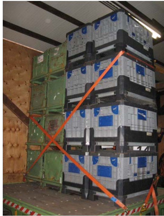
Abb. 31 Seitliche Diagonalverzurrung der LT 2671 über Füße der 4. Ebene
